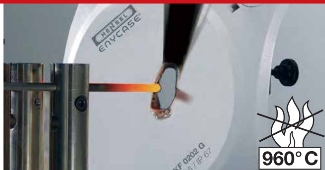
難燃性 UL94 V-0 をクリア。自己消火性ポリカーボネート樹脂採用。 < グローワイヤ検査基準 IEC (JIS C) 60695-2-11 960°C >
