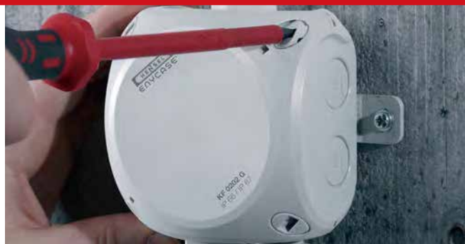
90 度ひねりのクイック開閉機構、スピーディーに作業ができます。 脱落のない「ふた一体型樹脂ロック」、開閉状況が目視でき、確認が容易。 トルク管理が不要なため、作業毎のバラツキがなく、シール性が安定します。
